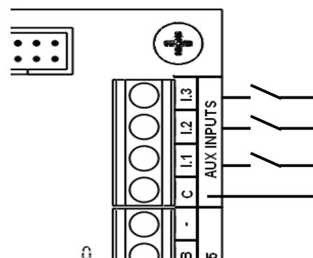
I tre ingressi digitali sono tutti configurabili dal software come N.O. oppure N.C.; impostando l'ingresso su OFF ne viene completamente ignorato il funzionamento.
