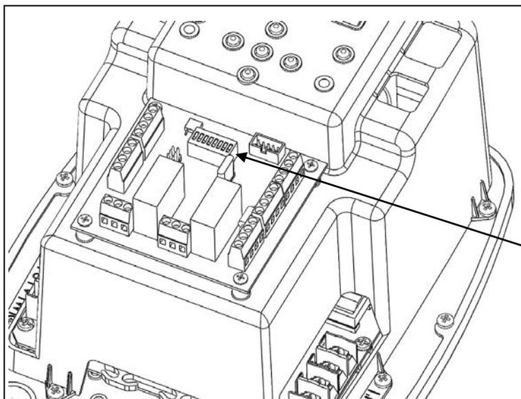
Tutti i dispositivi vengono forniti con indirizzo impostato ad "1" come regolazione di fabbrica, idoneo quindi per il funzionamento singolo. Nel caso di impiego con collegamento seriale è necessario impostare un indirizzo diverso per ogni inverter collegato.
