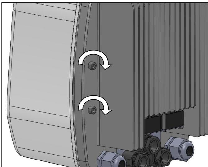
2) Pre assemblare le viti di fissaggio sul lato posteriore del Nettuno, lasciando almeno 3 mm di spazio sotto alle teste delle viti.
