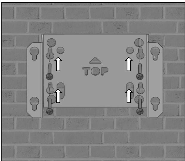
1) Fissare la staffa al muro per mezzo delle 4 viti in dotazione. Verificare il corretto allineamento orizzontale.
