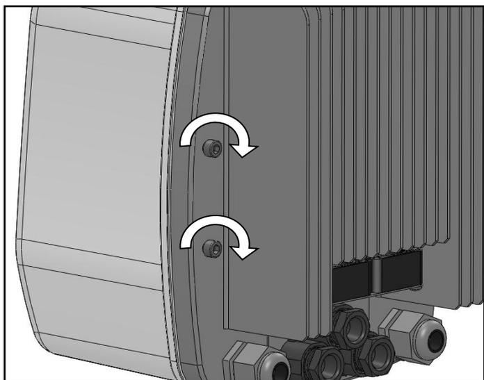
3) Pre assemblare le viti di fissaggio sul lato posteriore del Nettuno, lasciando almeno 3 mm di spazio sotto alle teste delle viti.
