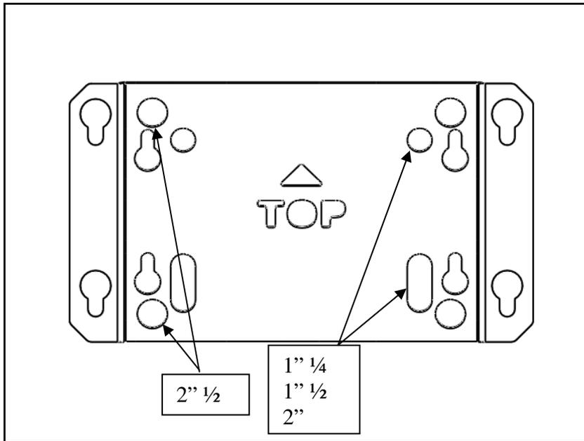
6) La staffa è predisposta per il fissaggio di ganci ad "U" di diverse misure, fare riferimento allo schema per il giusto utilizzo.
