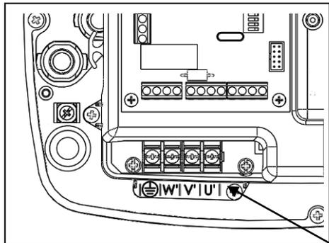
La sezione dei cavi consigliata è di 2,5mm<sup>2</sup> per lunghezze del cavo da 2 fino a 30 metri. Lunghezze superiori dei cavi, seppure adottabili, non sono state testate per gli standard EMI/RFI e devono essere valutate dal costruttore.
