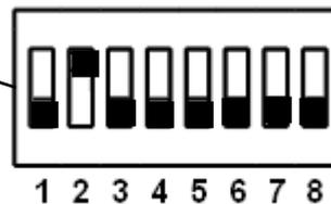
**⚠ Il valore dell'indirizzo seriale che viene determinato tramite il dip-switch sulla scheda di I/O dovrà essere in seguito inserito nel software di ciascun dispositivo al momento della prima accensione.**
