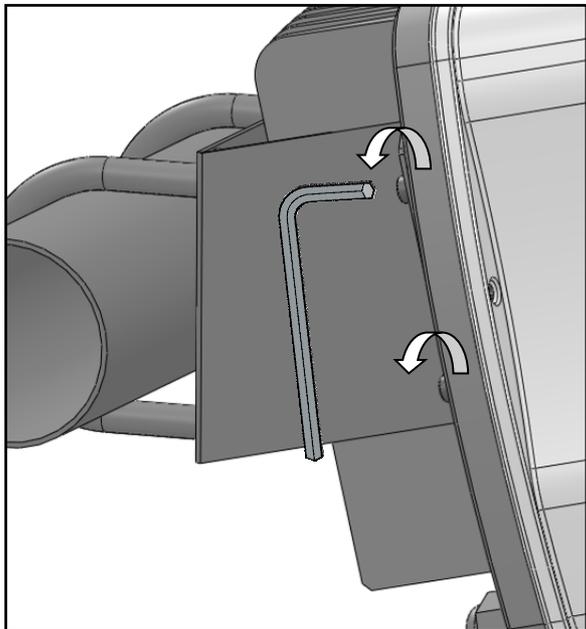
5) Fissare completamente le viti posteriori sul Nettuno.
